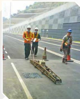
▲ 工務區域試驗所會安排地盤實地測試服務，包括土壤密度、馬路漆油的抗滑度和路面紋理深度及規律性等。
